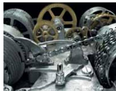
que absorbían demasiada energía, especialmente la cadena y los rodillos (23 cm de cadena compuesta de 450 eslabones de acero inoxidable remachados a mano). En pocos meses consiguieron mejorar la fiabilidad, la precisión y, sobre todo, la viabilidad del proyecto.
